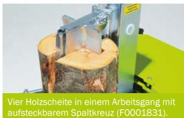
Vier Holzscheite in einem Arbeitsgang mit aufsteckbarem Spaltkreuz (F0001831).
