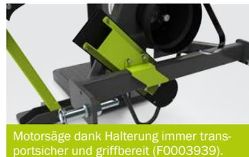
Motorsäge dank Halterung immer transportsicher und griffbereit (F0003939).
