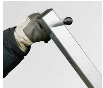
3 Mit dem Transportgriff des Paldu 9E kippen Sie den Holzspalter einfach auf die Räder und ab geht's zum Einsatzort.
