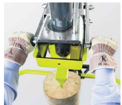
Die Zwei-Hand-Sicherheitsschaltung garantiert bequeme und sichere Bedienung.
