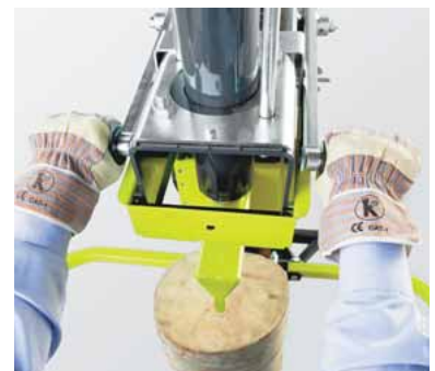
Die Zwei-Hand-Sicherheitsschaltung garantiert bequeme und sichere Bedienung.
