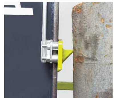
1 Die patentierte Holzhaltespitze aus dem Hause Posch fixiert auch dünnes und schräg abgeschnittenes Holz einwandfrei.
