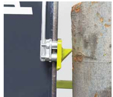
① Die patentierte Holzhaltespitze aus dem Hause Posch fixiert auch dünnes und schräg abgeschnittenes Holz einwandfrei.
